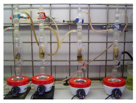
Figura 4.5 – Extração via soxhlet convencional.
