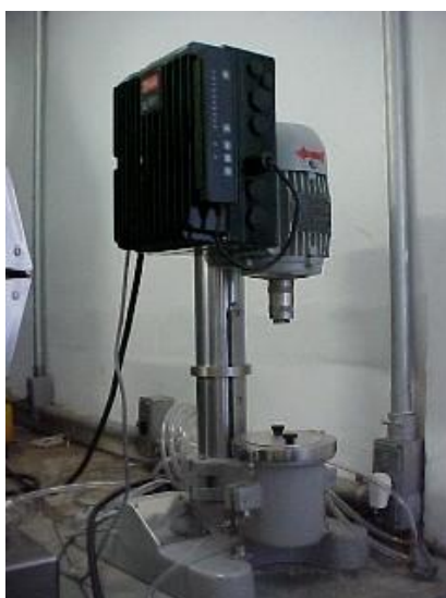
Figura 3.1: Moinho de alta energia do tipo atritor utilizado no processamento dos pós.
