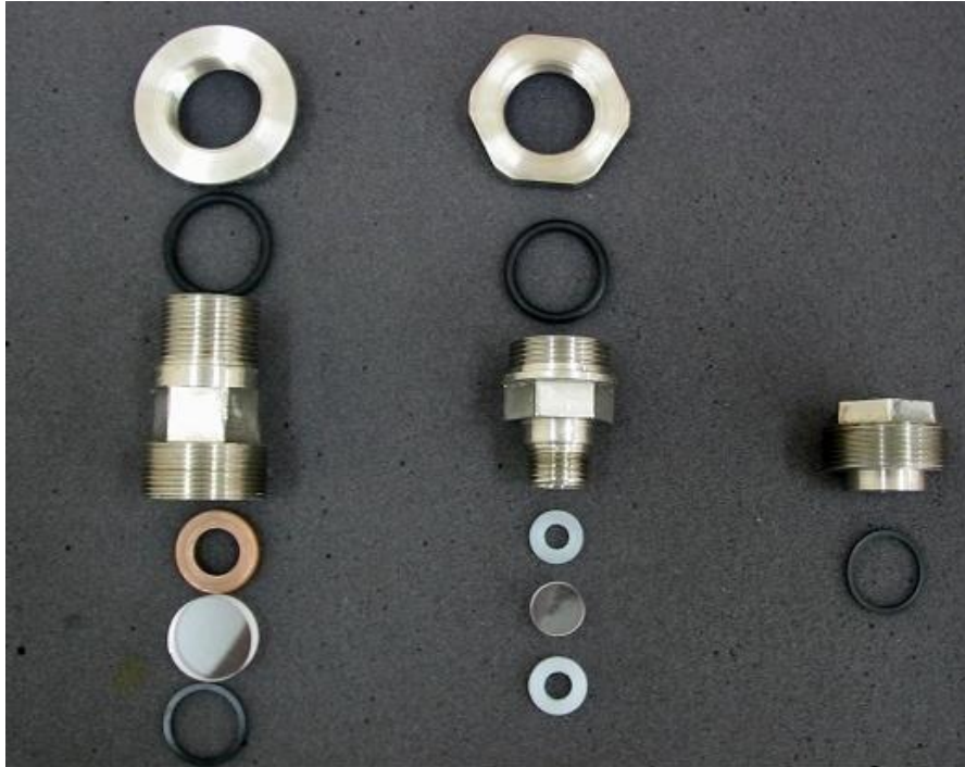
Figura 4.4.: Conexões da célula de equilíbrio, bem como anéis de vedação, anel de cobre e as respectivas janelas de safira.
