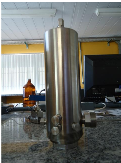
Figura E.1. Célula de alta pressão desenvolvida para suportar 500 bar de pressão.
