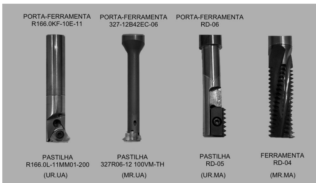
Figura 24 - Ferramentas e porta-ferramentas utilizados nos experimentos.
