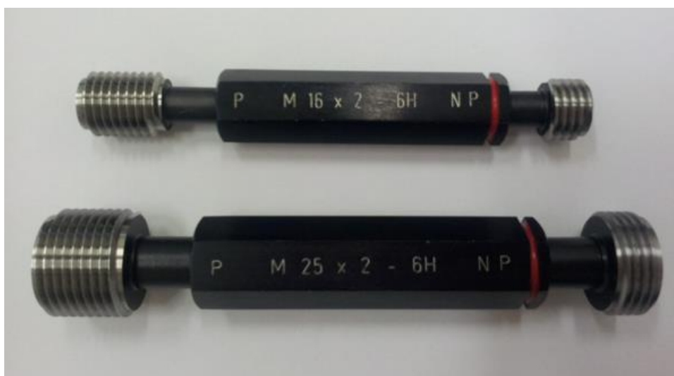
Figura 30 - Calibradores P-NP para inspeção das roscas M16 e M25.
