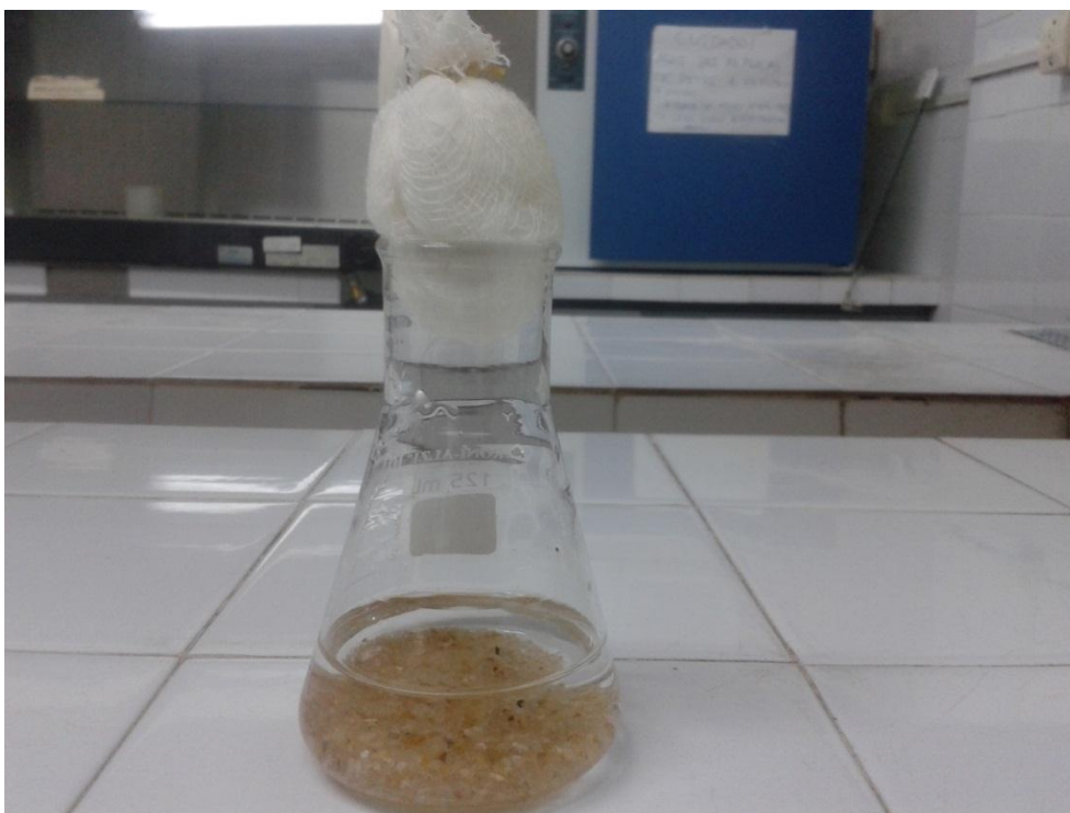
Figura 14: Mecanismo para transferência das bactérias da areia para água.
