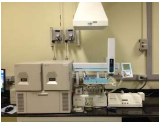
Figura 3.1. Analisador de enxofre Antek 9000NS.
