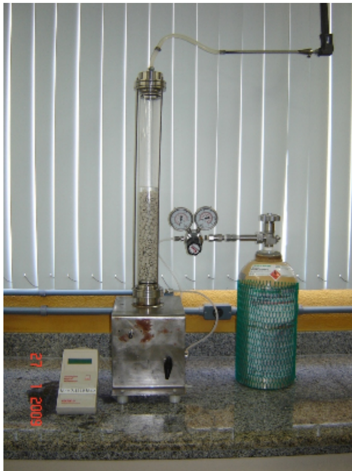
Figura 4.5. Ensaio de absorção em operação
