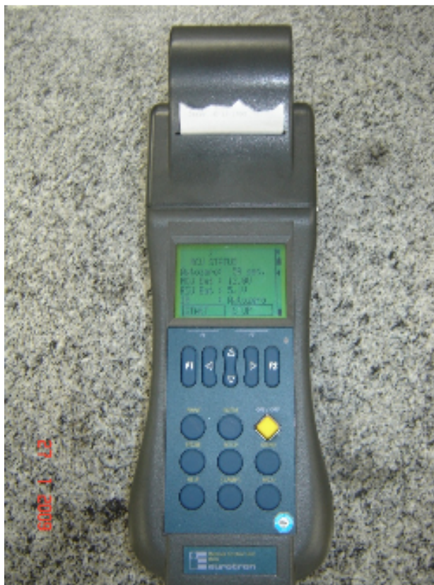
Figura 4.7. Controle remoto da unidade de análise de H 2 S.
