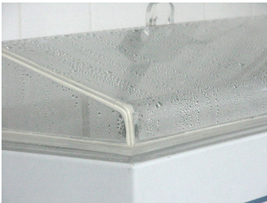
Figura 16a: Detalhe da condensação
