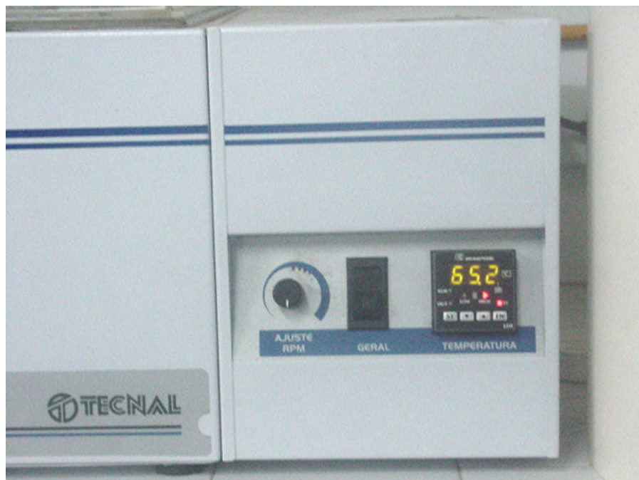
Figura 14: Detalhe do banho termostático, sistema de controle da temperatura
