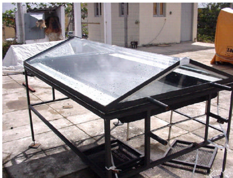
Figura 12: Visão frontal do destilador e dos dispositivos de coleta e água destilada e resíduo
