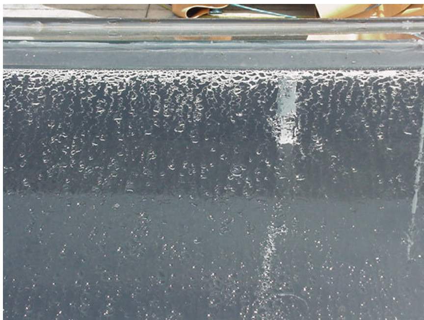
Figura 33: Gotas de água condensadas na cobertura do destilador
