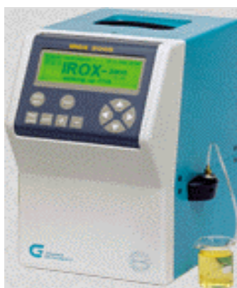
FIGURA 3.6. Equipamento IROX 2000 utilizado para obter a octanagem, curva de destilação e densidade do C5+.
