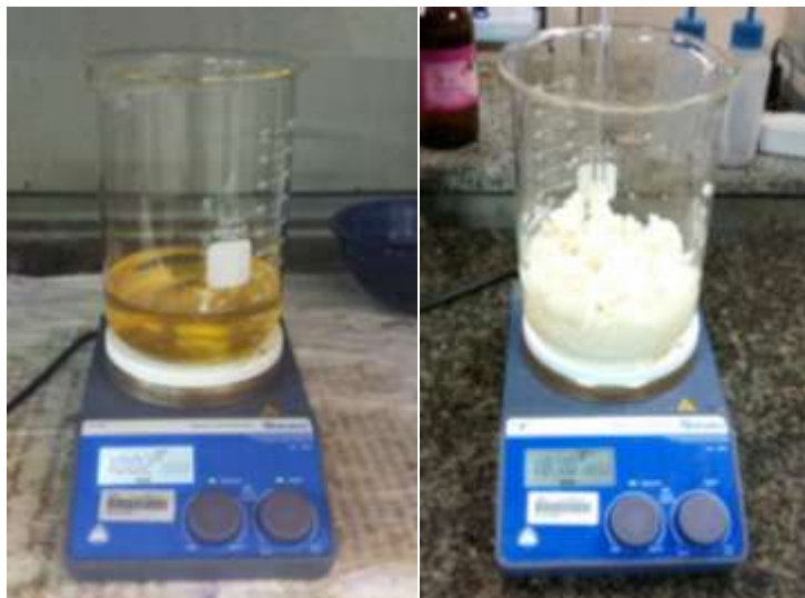
Figura 13 – Processo de saponificação do óleo de coco. A figura da esquerda mostra o início do processo e a da direita o OCS cristalizado.
