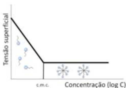
Figura 9 – Distribuição de um tensoativo em solução aquosa.
