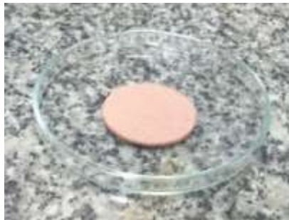
Figura 18 – Pastilha de rocha arenito utilizada no ensaio de molhabilidade.
