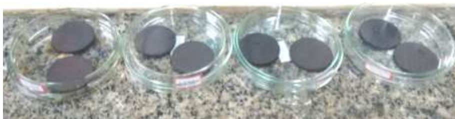
Figura 19 – Pastilhas de arenito após o tratamento final com microemulsão.
