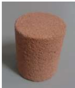
Figura 16 – Plugue de arenito da formação Botucatu.
