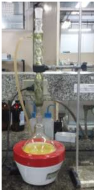
Figura 12 – Sistema de refluxo para síntese de OCS.
