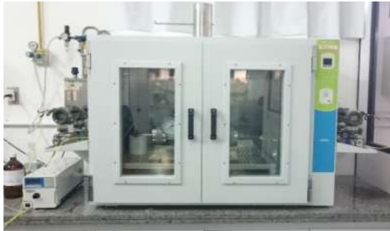
Figura 21 – Equipamento de recuperação core flooding system .
