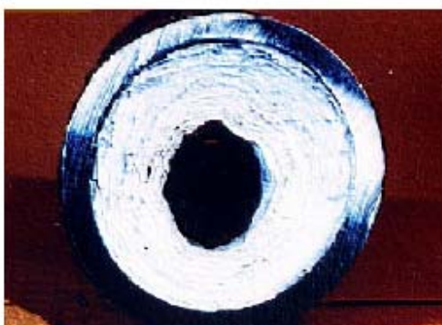
Figura 2.5: Incrustação a base de cálcio, magnésio, sílica e fosfato
