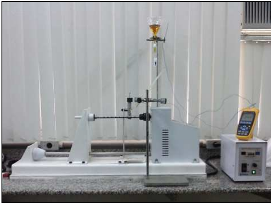
Figura 31: Bancada do ensaio de desgaste relativo ao atrito.
