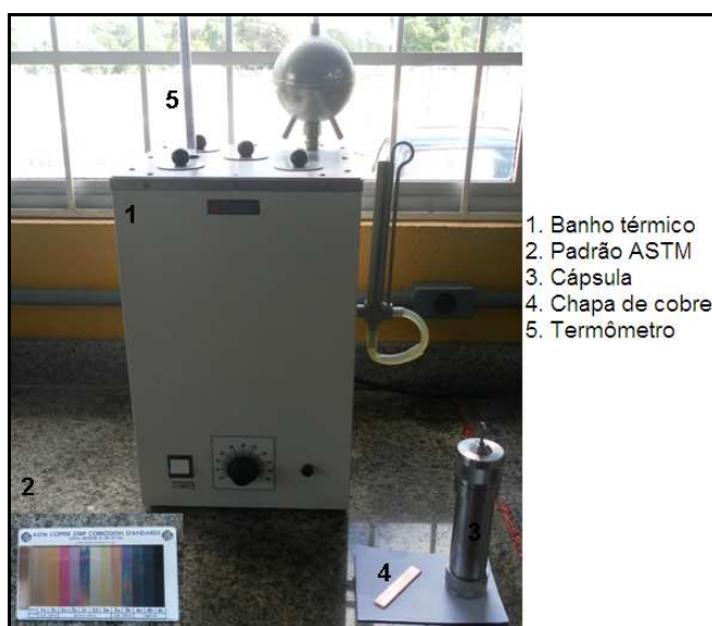
Figura 27: Equipamento e materiais do ensaio de corrosão.
