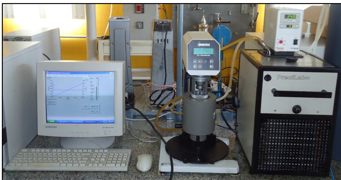
Figura 23: Ao centro o Reômetro Brookfield, à esquerda o software sendo executado e à direita o banho térmico com regulagem de temperaturas.
