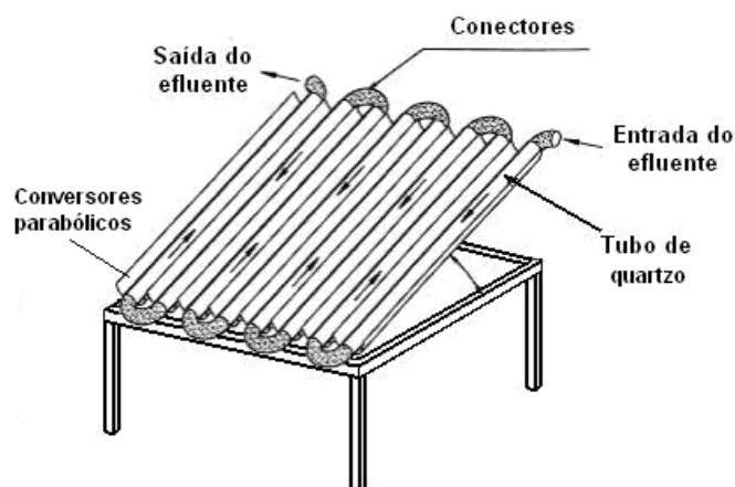
Figura 2.4.1 Esquema do reator solar tubular parabólico.
