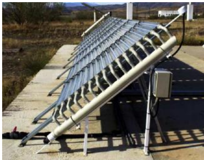
Figura 2.4. Coletores parabólicos desenvolvidos para aplicação fotocatalítica. (Fonte: Malato et al. 2003)
