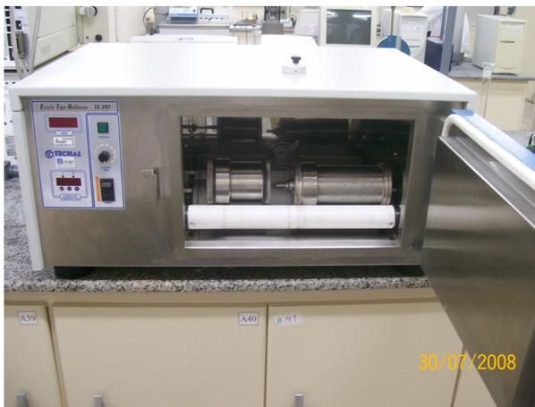
Figura 05 – Estufa Roller Oven para teste de envelhecimento
