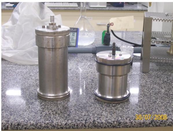
Figura 04 – Células de envelhecimento para alta e baixa pressão
