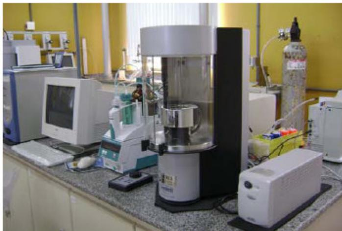
Figura 03 – Tensiômetro Krüss
