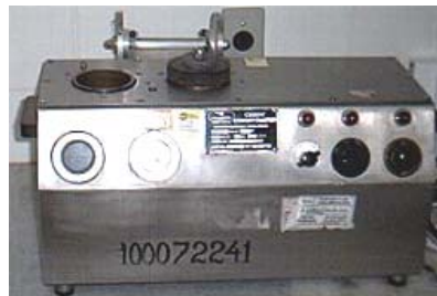
Consitômetro atmosférico: Utilizado para homogeneização da pasta de cimento.
