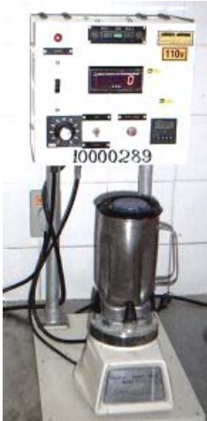
Waring Blender Mixing: Utilizado na preparação da pasta de cimento.
