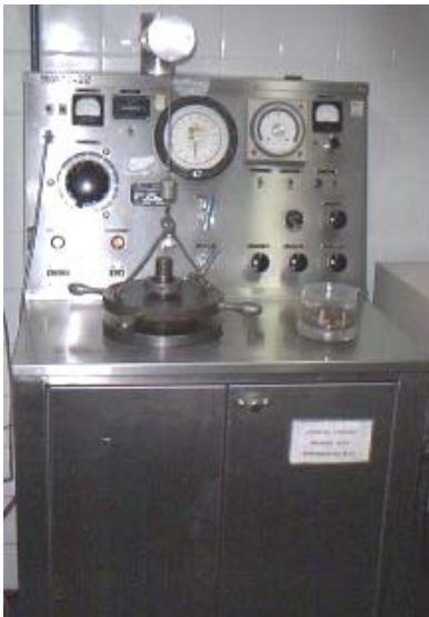
Consistômetro Pressurizado: Utilizado nos testes de espessamento e de estabilidade
