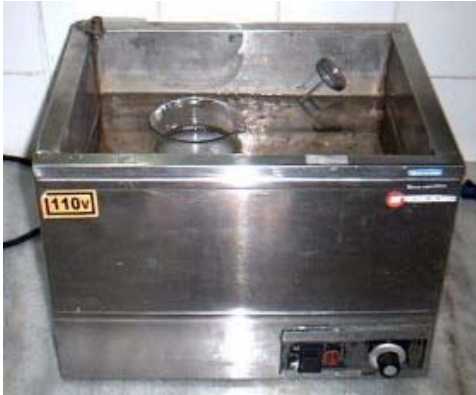
Banho maria: Utilizado nos testes de quebra do gel utilizado nas operações de fraturamento
