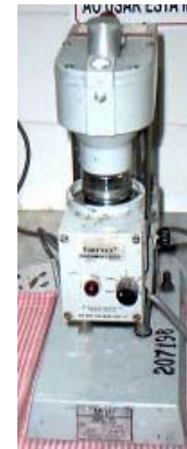
Viscosímetro: Utilizado nos testes de reologia
