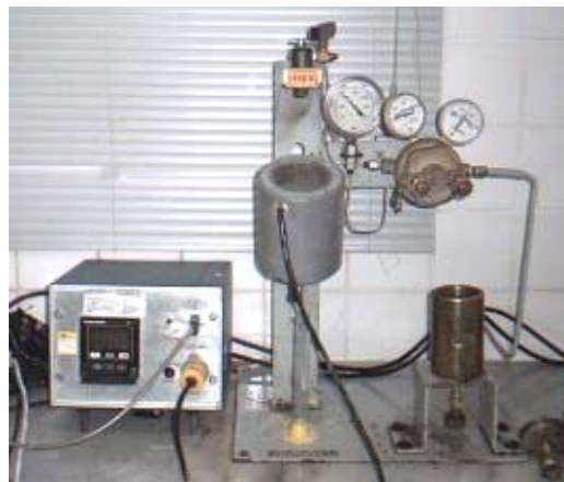
Fluid Loss: Utilizado nos testes de perda de filtrado.
