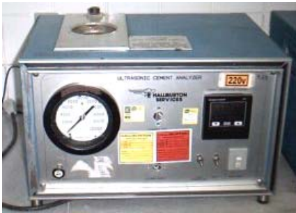
UCA (Ultrasonic Cement Analyzer): Utilizado nos testes de resistência compressiva (método não destrutivo)
