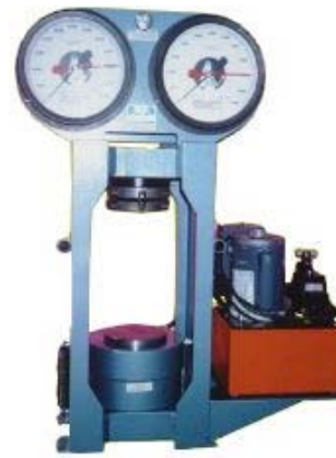
Prensa Hidráulica: Utilizado nos testes de resistência compressiva (método destrutivo)
