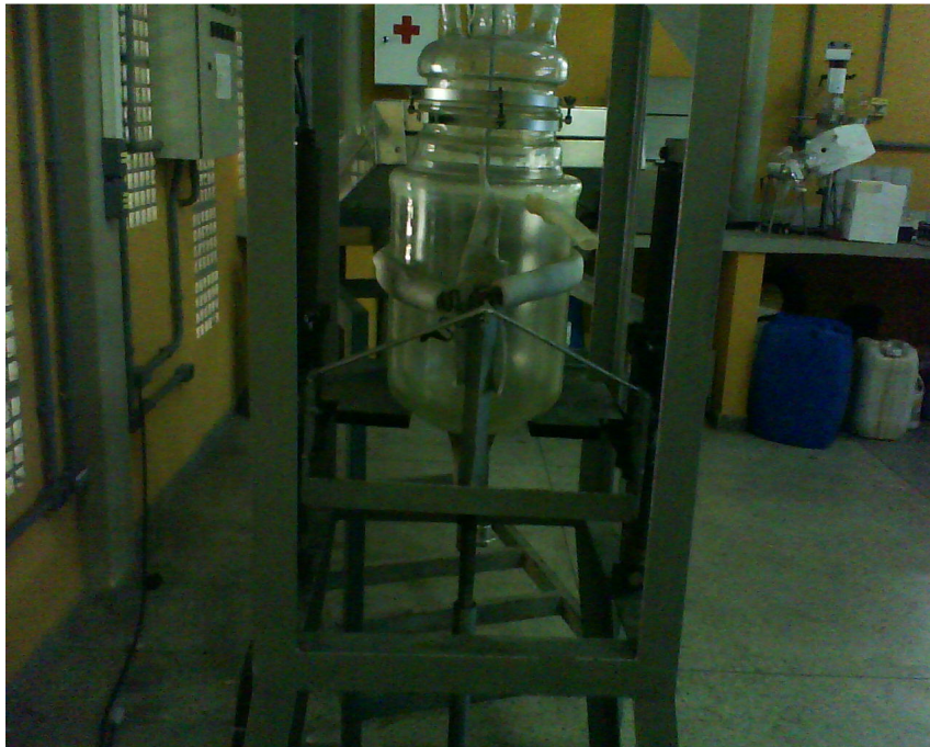
Figura 04: Reator com capacidade de 3L para produção do Biodiesel
