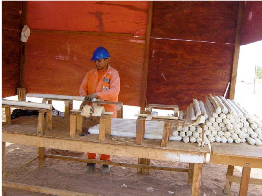
Figura 4.7. Preparação de cargas de 2 kg de powergel na área do armazém de explosivos.
