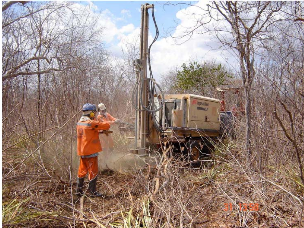
Figura 4.5. Sonda utilizada na perfuração de PTs na área do projeto.
