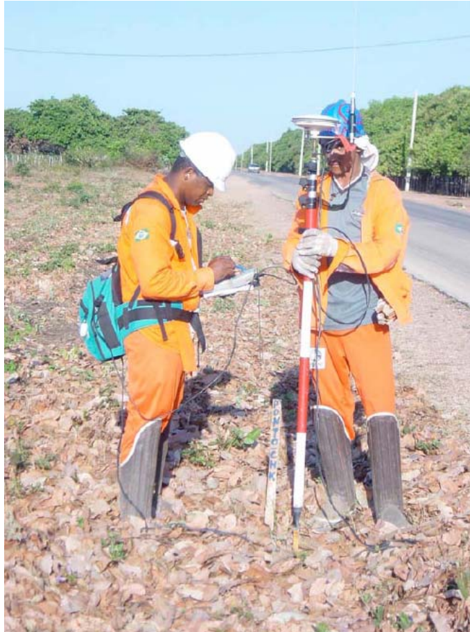
Figura 4.4. Verificação diária dos equipamentos GPS.
