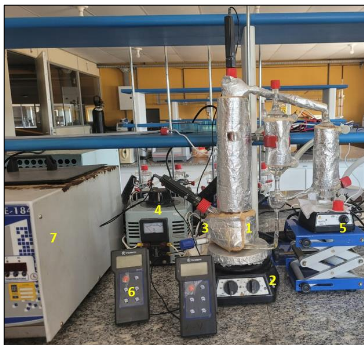
Figura 8 - Aparato experimental para obtenção de dados de equilíbrio líquido-vapor.
