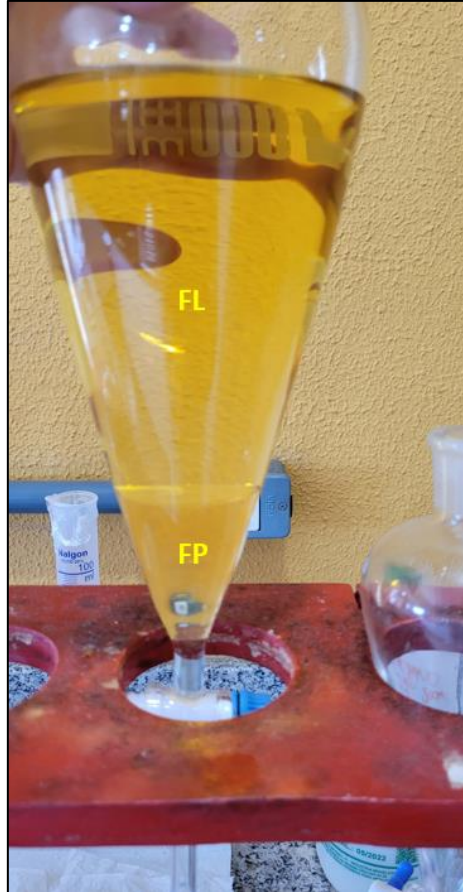
Figura 7 - Etapa de decantação - separação das fases leve e pesada.
