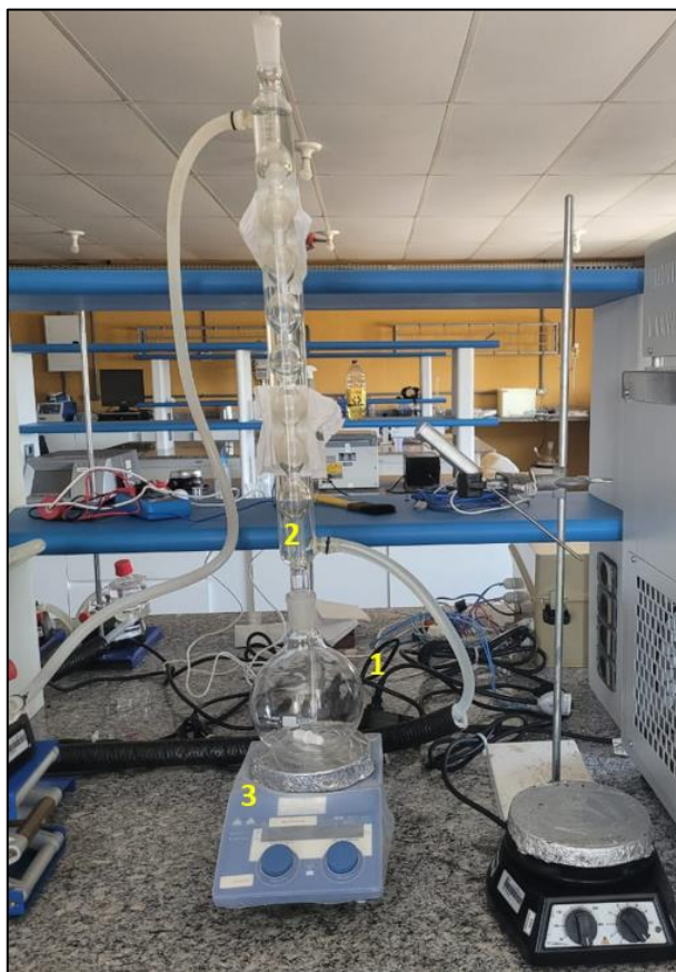
Figura 6 - Aparato experimental para obtenção de dados de equilíbrio líquido-vapor.
