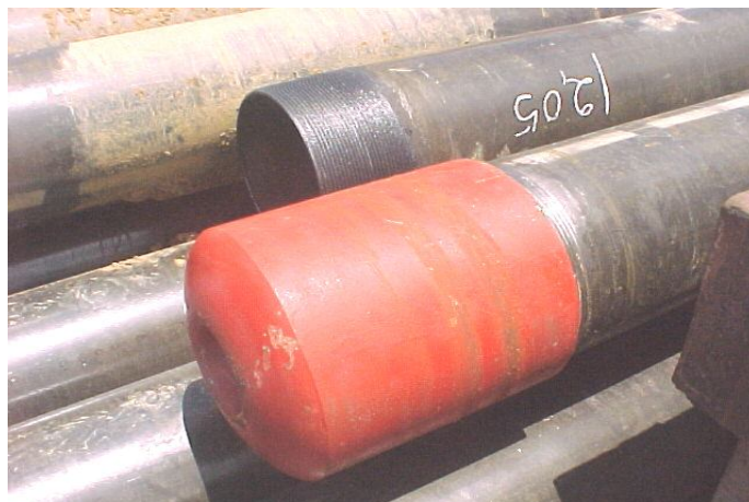
Figura 16: Sapata de revestimento de superfície.
