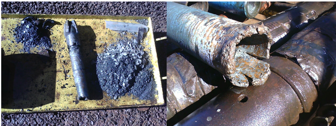
Figura 15: Pescaria: À esquerda, Cement Retainer e cascalho de cimento. À direita, Sapata Mill danificada após cortar e encamisar o Cement Retainer
