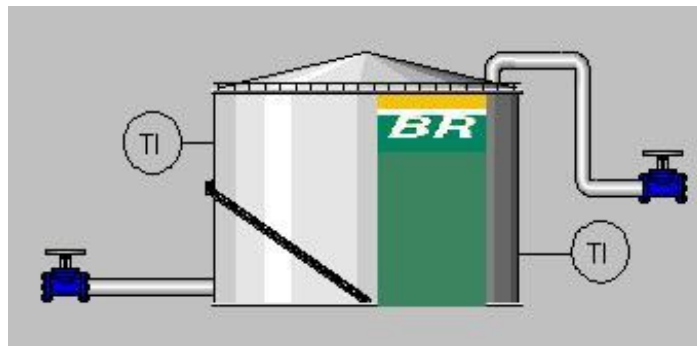
Figura 12: Desenho esquemático de posicionamento de termômetros e válvulas em tanque de óleo.
