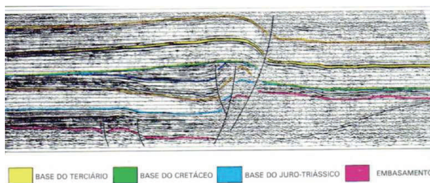
Figura 2.1: Exemplo de dados obtidos através de sísmica. Fonte: [Vidal 2008]
