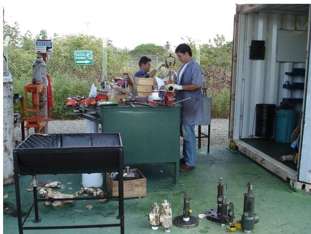
Fig. 4– Calibração de Válvula de segurança em campo.
