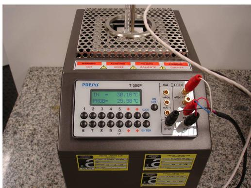
Figura 2 - Calibrador de temperatura
