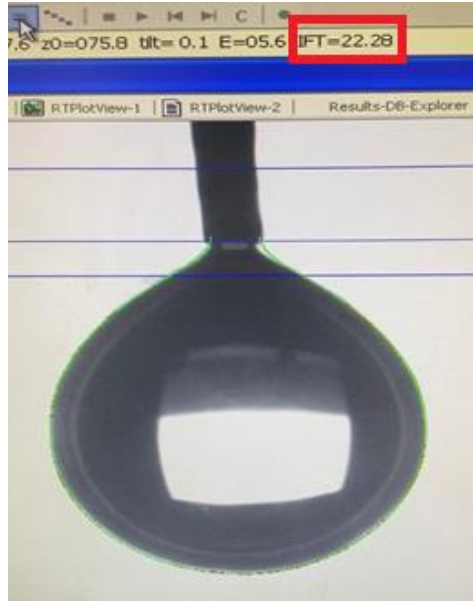
Figura 24. Tensão interfacial mostrado pelo programa DSA100.
