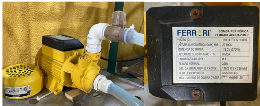
Figura 12. Bomba Periférica Ferrari Acquapump 370 W com uma válvula PVC 25 mm.
