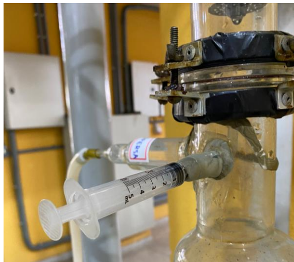
Figura 15. Entrada do traçador na coluna no estudo de dispersão axial.
