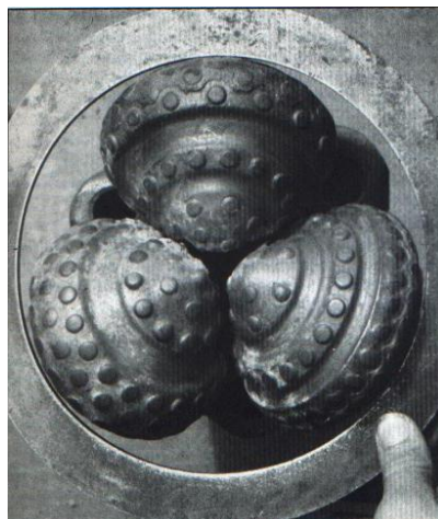
Figura 8 - Broca desgastada, porém estando calibrada. Fonte: Disponível em < http://www.4shared.com/all-images/wl4AQQIP/Brocas.html?&firstFileToShow=100 > Acesso em 19 de mar. de 2013.
