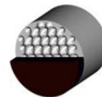
A interfase não-plana da superfície entre os materials ajuda a aliviar as tensões internas nos cortadores
