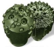
Primeiras brocas PDC. Hastes insertadas no corpo de aço das brocas com arranjo simples em espiral
