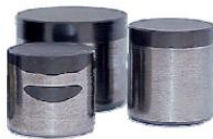
A espessura da capa de diamante pode ser incrementada para dar mais durabilidade ao cortador PDC. Primeiro plano: cortador TECMAX
