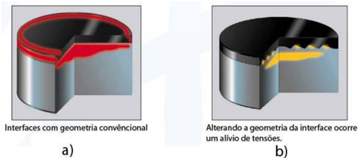
Figura 19 - Técnica para alívio de tensões em pastilhas de PDC (Fonte: BAKER HUGHES, 2008).
