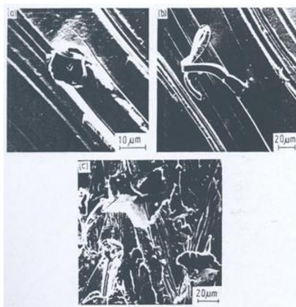
Figura 23 - Micrografias da superfície dos sólidos que sofreram desgaste abrasivo (a) microsulcamento, (b) microcorte (c) microlascamento - Fonte (GAHR,1987)
