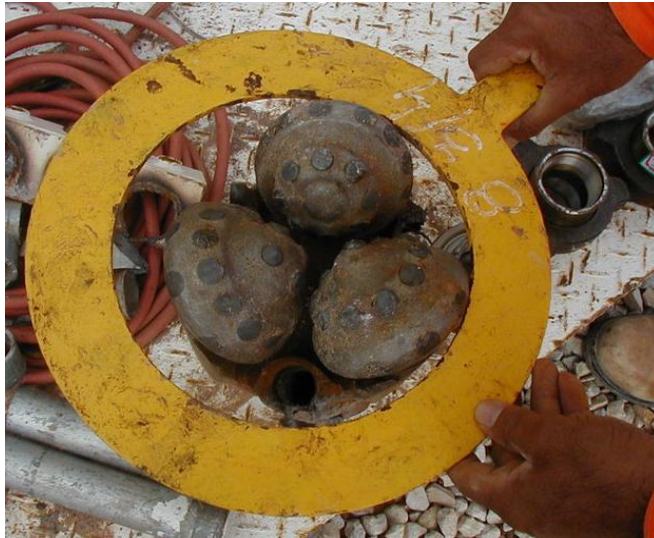
Figura 7 - Broca de inserto desgastada sem calibre. Fonte: Disponível em < http://www.4shared.com/all-images/wl4AQQIP/Brocas.html?&firstFileToShow=100 > Acesso em 19 de mar. 2013.
