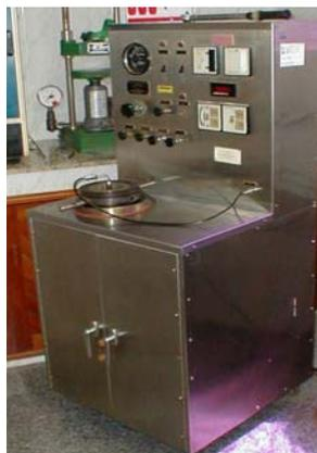
**Figura 6 – Câmara de Cura, Conforme Item 3.2 da norma ABNT - NBR 9828/87.**
