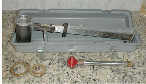
**Figura 8 – Balança Pressurizada, Conforme Descrito na Norma API Spec 10 –Apêndice C – Agosto de 1988.**
