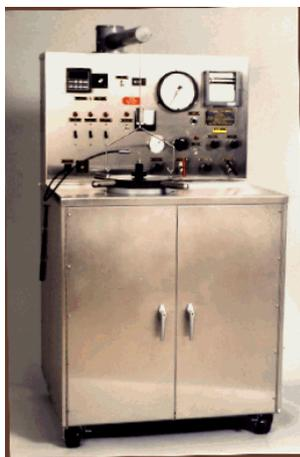
**Figura 5 – Consistômetro Pressurizado, Conforme Item 4.1 da Norma ABNT - NBR – 9829/87.**
