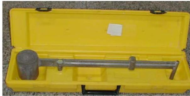
**Figura 7 – Balança de Lama, Conforme Descrito na Norma API RP13B – Maio de 1982.**
