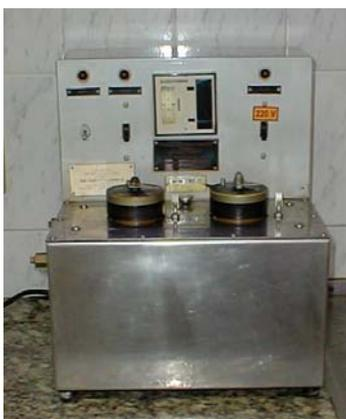
**Figura 2 – Consistômetro Atmosférico, Conforme o Item 4.1 da Norma ABNT - NBR 9826/87.**
