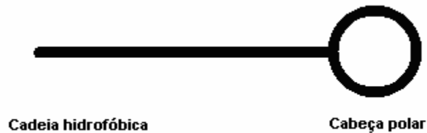
Figura 1: Estrutura de uma molécula de tensoativo
