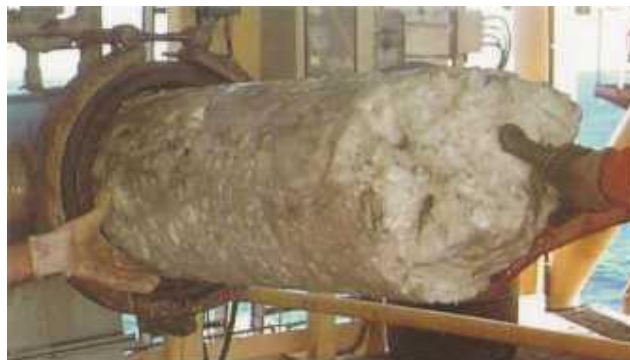
Figura 13: Bloco de hidrato retirado da extinta plataforma 36 – PETROBRAS.
