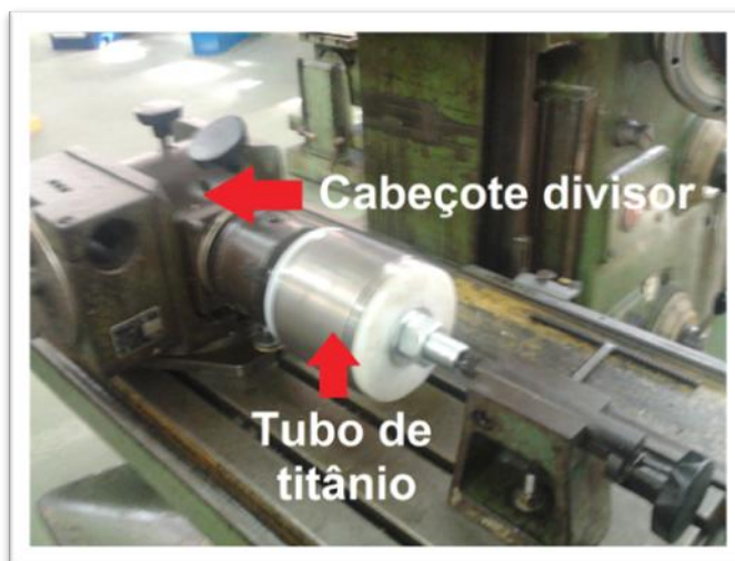
Figura 28 - Tubo de titânio posicionado na fresadora para a abertura dos furos.
