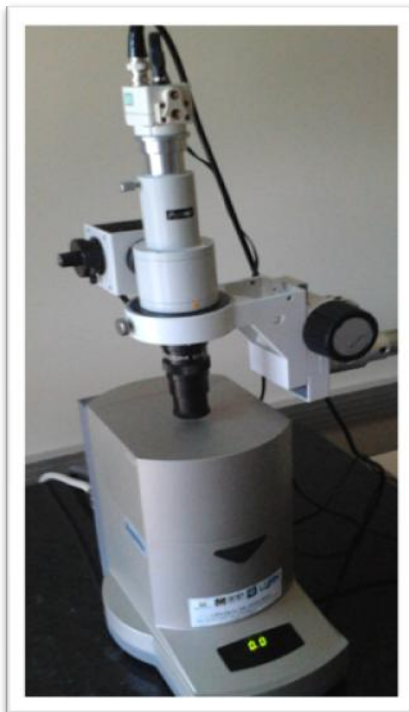
Figura 21 - Microscópio de Força Atômica usado para avaliação da rugosidade das superfícies do inserto de metal duro.
