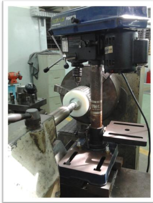
Figura 30 - Furadeira de bancada adaptada no torno mecânico para a operação de escareamento.
