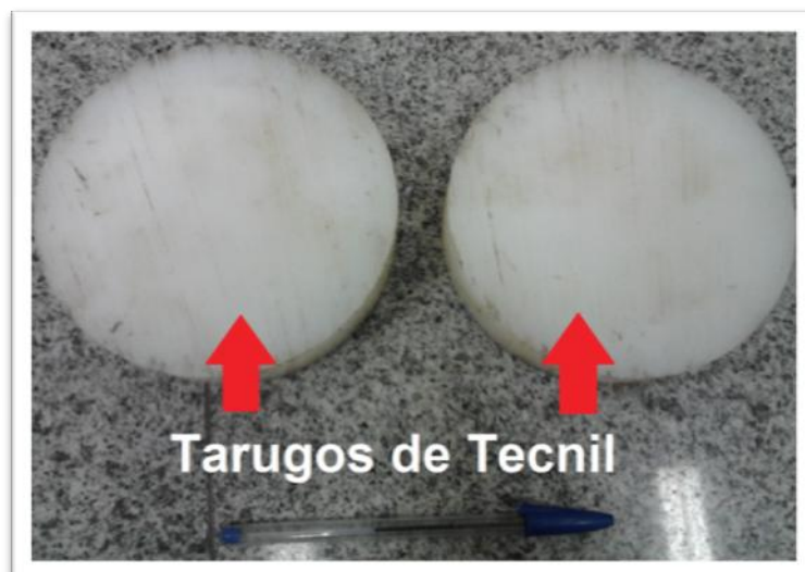
Figura 25 – Discos de tecnil usados para auxiliar a fixação do tubo de Titânio para sua usinagem.
