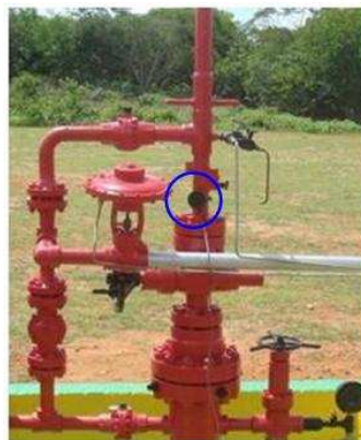
Figura 2.7: Localização do sensor magnético em campo (Lorena - Mossoró/RN).
