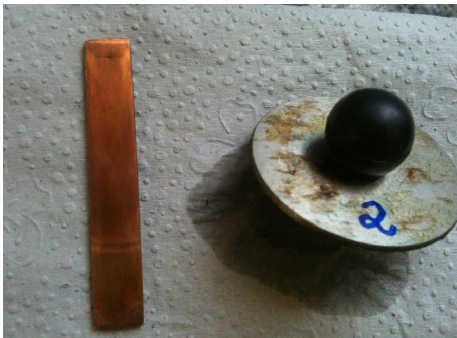
Figura 14: Teste de corrosão ao cobre "caso 2".
