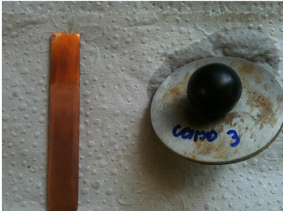
Figura 15: Teste de corrosão ao cobre "caso 3".
