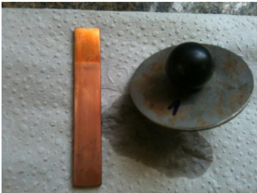
Figura 13: Teste de corrosão ao cobre "caso 1".
