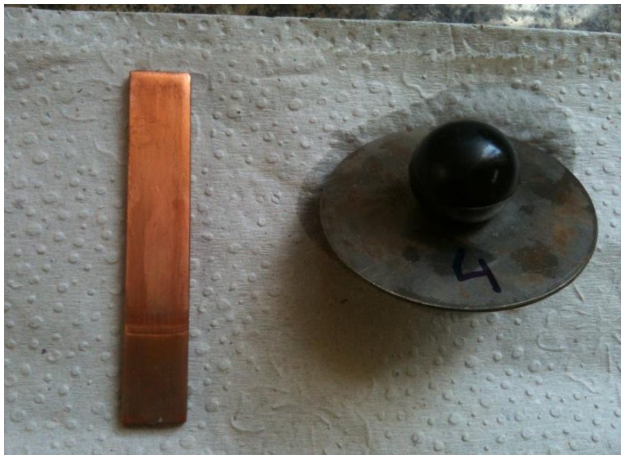
Figura 16: Teste de corrosão ao cobre "caso 4".
