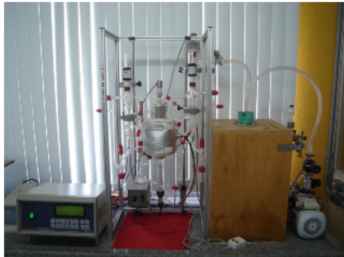
Figura 6.1. Ebuliômetro Fischer acoplado ao controlador M101, Bomba à vácuo e sistema de refrigeração
