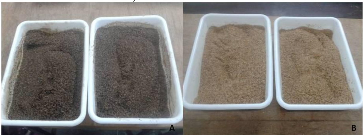
Figura 12: Microcosmos utilizados para o ensaio de biorremediação. A) Contaminado com óleo bruto B) Contaminado com diesel.
