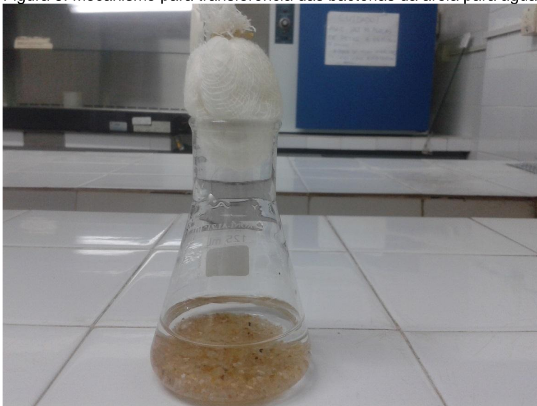
Figura 6: Mecanismo para transferência das bactérias da areia para água.
