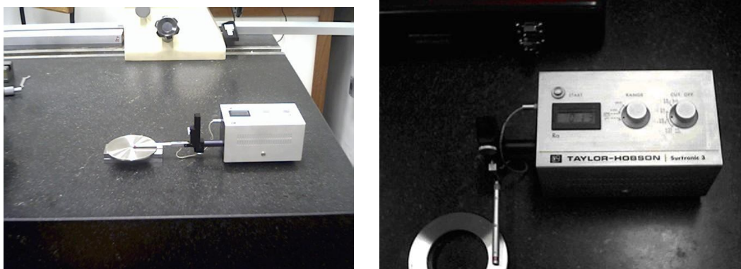
Fig. 16 - Medição de rugosidade superficial de placas de orifício.
