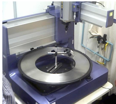
Figs. 28 e 29 - Calibração de placas de orifício por coordenada no laboratório de metrologia da UFRN.
