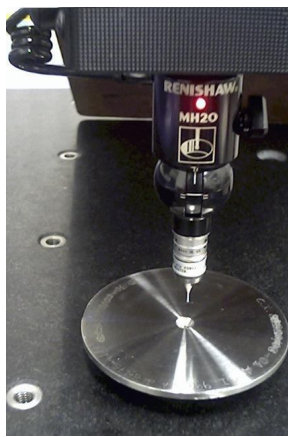
Figs. 28 e 29 - Calibração de placas de orifício por coordenada no laboratório de metrologia da UFRN.
