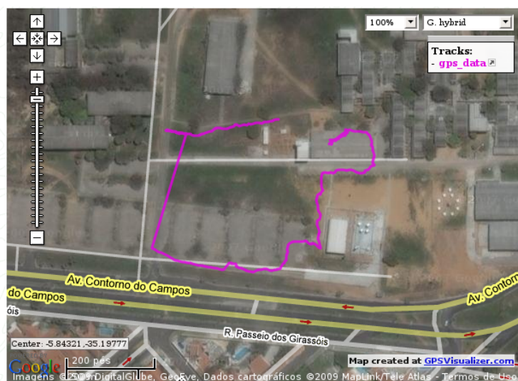
Figura 3.12: Experimento realizado com o objetivo de validar o funcionamento do GPS. Se nota um erro no canto superior esquerdo.
