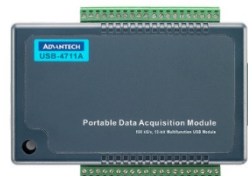
Figura 19. Placa de aquisição de dados – USB-4711A (ADVANTECH, 2014).
