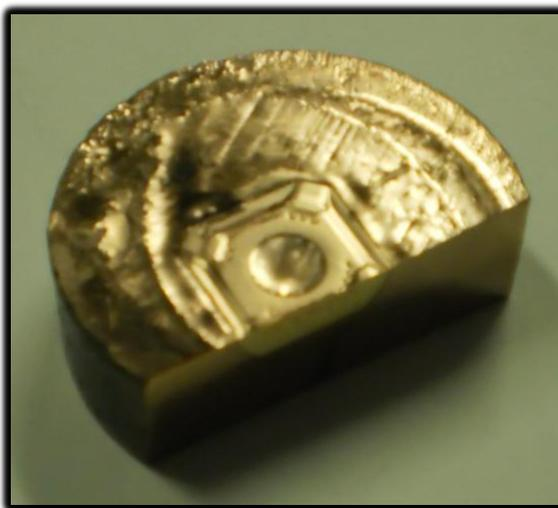
**Figura 20 – Ferramenta cortada e embutida, preparada para análise.**
