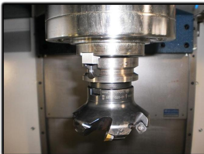
**Figura 23 – Fresa usada durante os ensaios.**
