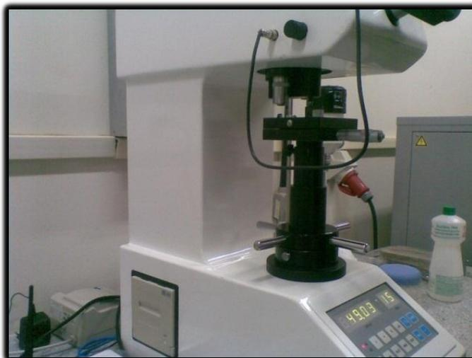
**Figura 16 – Processo de ensaio de dureza do tipo vickers.**
