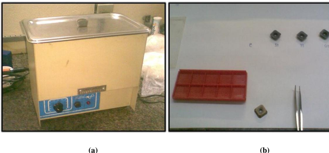
**Figura 27 – (a) aparelho de ultra-som. (b) Ferramentas após processo de limpeza.**
