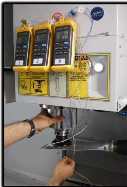
**Figura 26 - Monitoramento da temperatura na saída do bico.**
