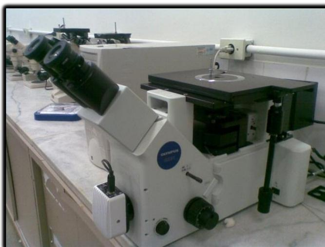
**Figura 14 – Microscópio usado para análise da micrografia do aço.**
