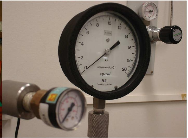
Figura 2 – Calibração de Manômetro
