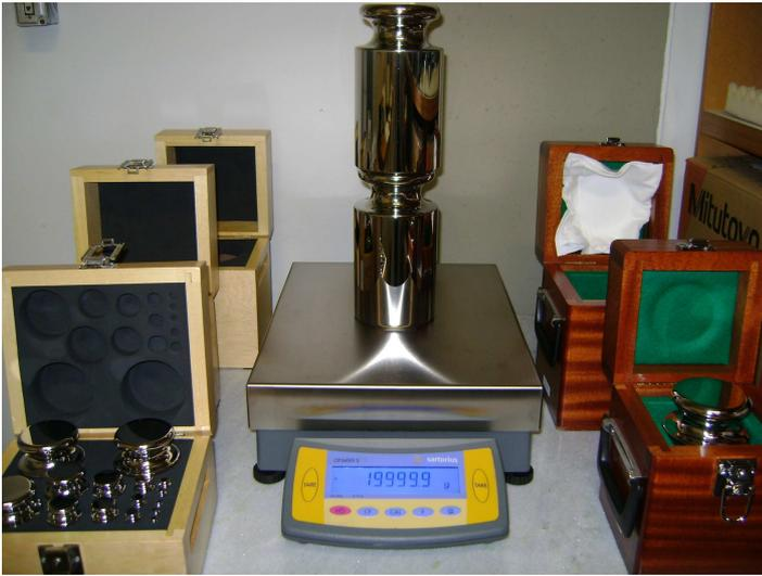
Figura 1 – Calibração de Balança
