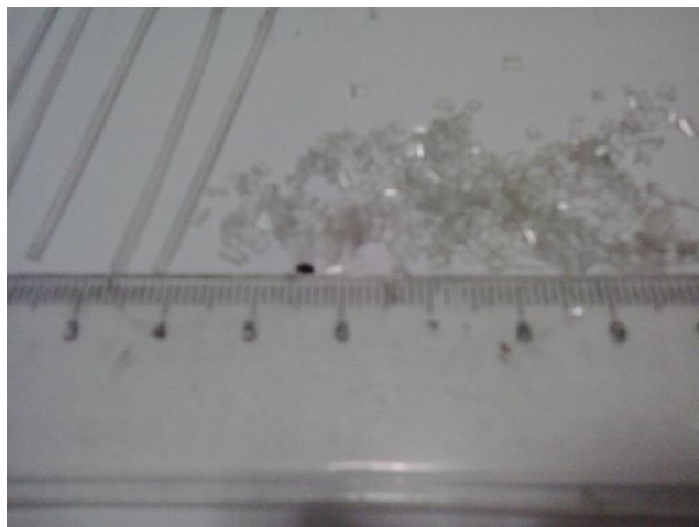
Figura 08 – PET utilizado na fabricação dos corpos de prova. À direita o PET fatiado e à esquerda picotado.
