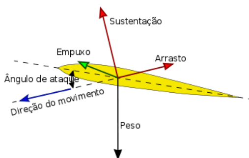
Figura 05: Forças atuantes em um aerofólio. (Fonte: http://pt.wikipedia.org/wiki/Sustenta%C3%A7%C3%A3o_%28aerodin%C3%A2mica%29 , junho de 2013).
