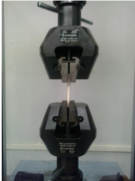
Figura 13 – Corpo de prova submetido à carga de tração.
