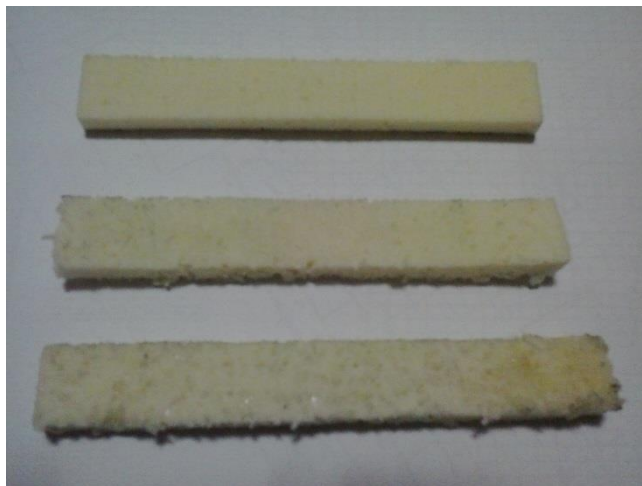
Figura 10 – Corpos de prova com as diferentes formulações. Sem PET acima, 15% em massa no meio, 30% em massa abaixo.
