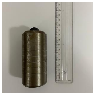
Figura 31 – Prumo com massa medida por balança convencional de 1 kg.
