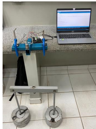
(d) Suporte do transdutor associado ao circuito do microcontrolador.
