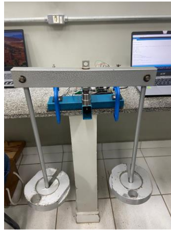
(b) Transdutor aferindo a massa de um par de anilhas, isto é, 10 kg.
