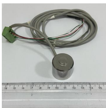
Figura 14 – Célula de carga de compressão com capacidade de 5 kN.
