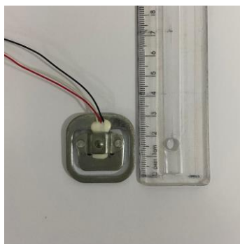
Figura 13 – Célula de carga de compressão com capacidade de 500 N.
