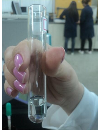
Figura 15 - Mistura de n-Parafina + tensoativo Unitol 30 (sistema incolor).
