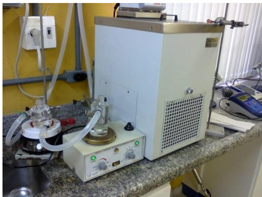
Figura 3.4 – Aparato experimental para realização dos testes de solubilidade de parafina nas temperaturas 20, 15, 10 e 5°C.
