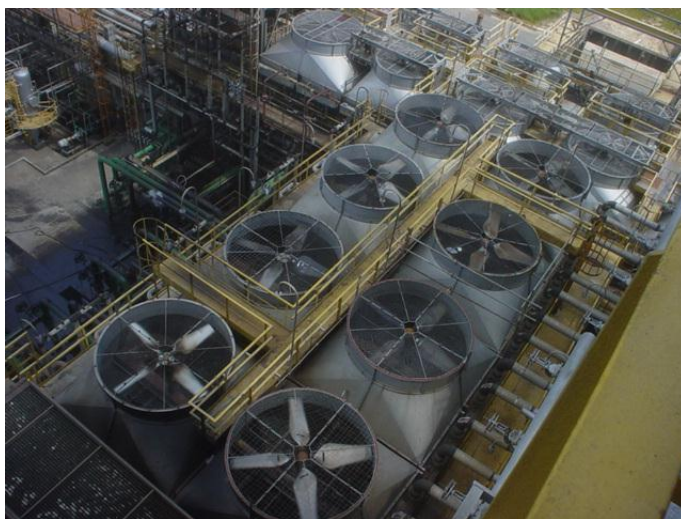
Figura 4.2 - Air-coolers (C-918) da U-9 e Modelo de um “Compabloc”
