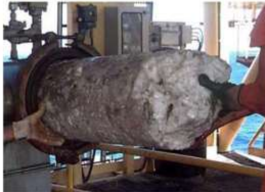
Figura 6 – Remoção de hidrato do interior de uma tubulação de gás natural.
