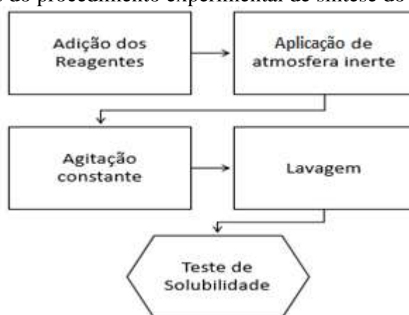
Figura 12 - Etapas do procedimento experimental de síntese do carbonato de ferro.
