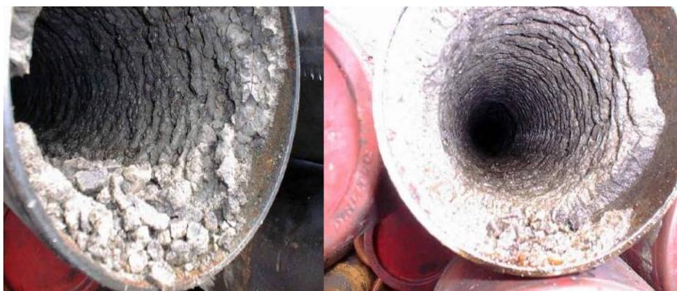
Figura 2.1: Incrustação provocada pela água produzida.
