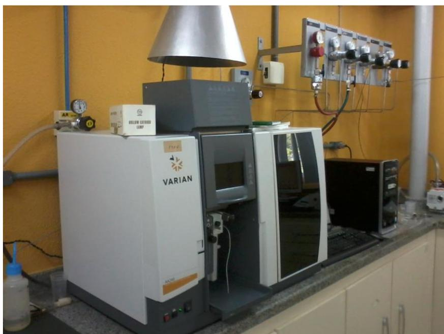
Figura 2.15: Espectrofotômetro de Absorção Atômica, SpectrAA – 20 plus, Varian
