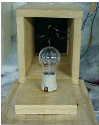
Figura 30 – Câmara de aquecimento e placa com termopares
