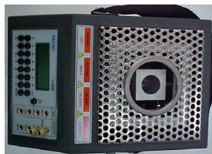
Figura 15 – PROBE do banho térmico tipo bloco seco(T-350P)
