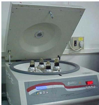
Figura 19 – Centrífuga com controle de temperatura
