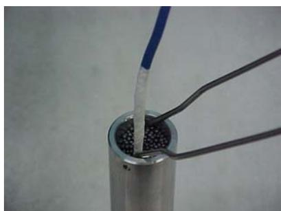
Figura 14 – Termopar inserido no insert com as esferas de aço
