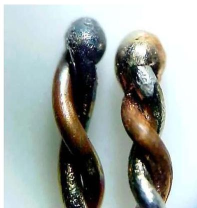
Figura 10 – Comparação das juntas sem e com a aplicação do gás argônio respectivamente.
