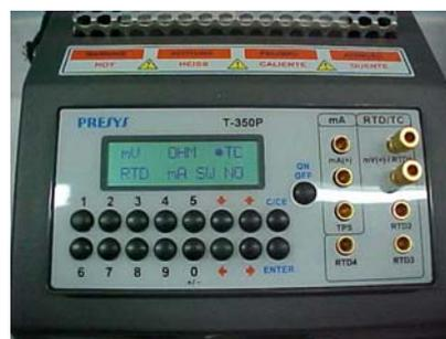
Figura 13 – Manuseio do T-350P, escolhendo o tipo de instrumento para entrada.
