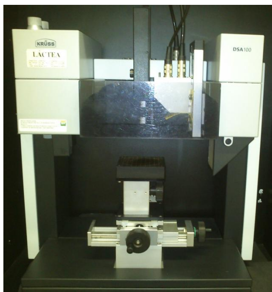
Figura 8: Equipamento utilizado para fazer as medidas de ângulo de contato: tensiômetro Kruss modelo DSA100.
