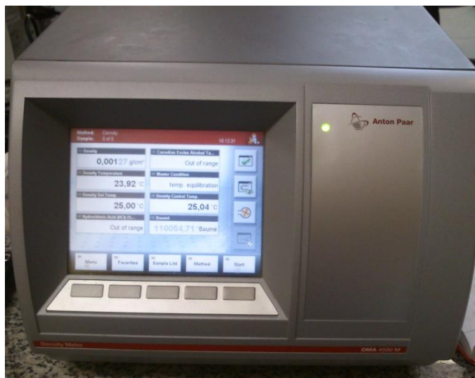
Figura 7: Equipamento utilizado na análise de densidade: densímetro Anton Paar, modelo DMA 4500 M.
