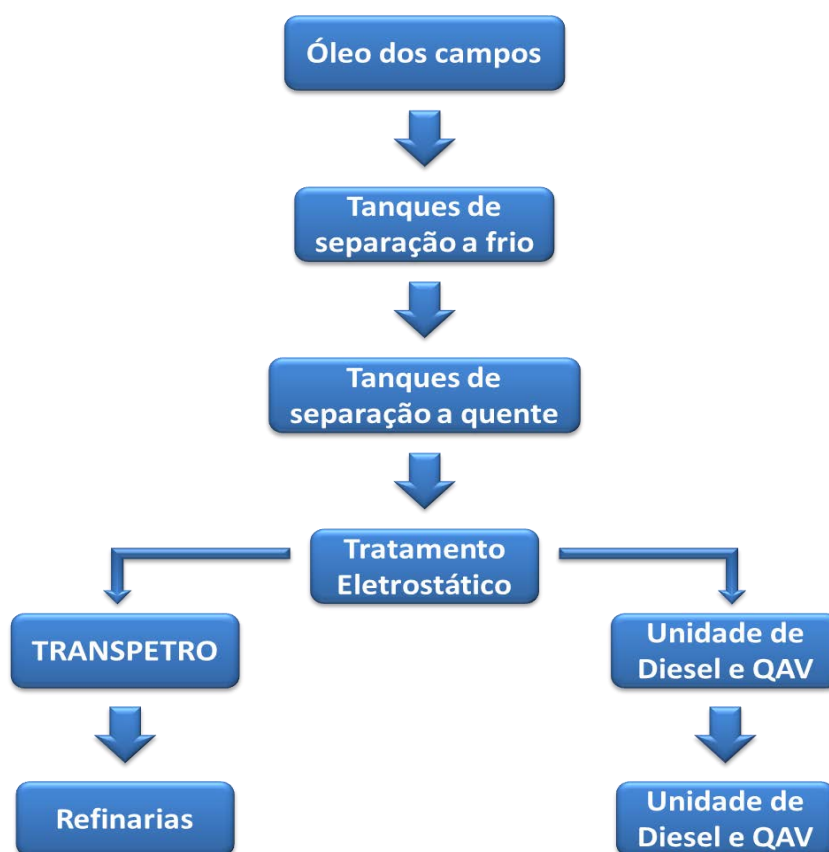
Figura 6: Diagrama de blocos do processo da ETO
