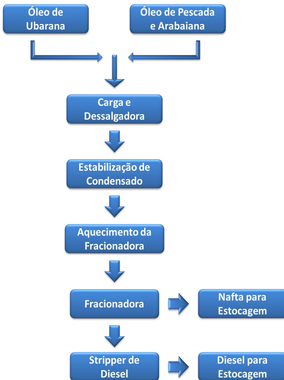
Figura 13: Diagrama de blocos do processo da Unidade de Diesel
