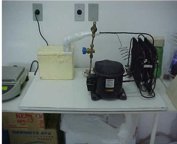
Figura 08 Bancada para testes de termoacumuladores.
