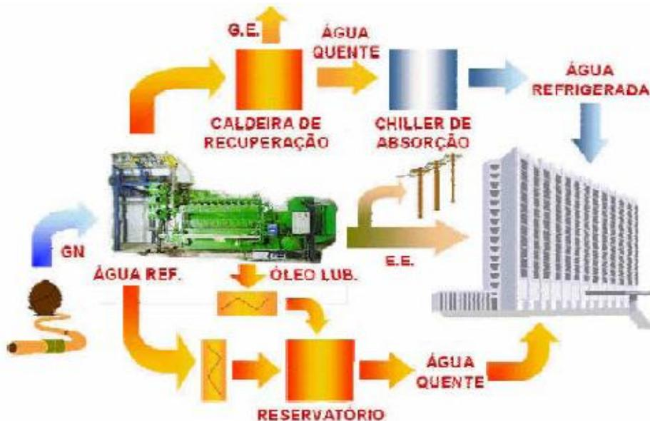
Fig.03 – Esquema típico de representação - Cogeração/Trigeração
