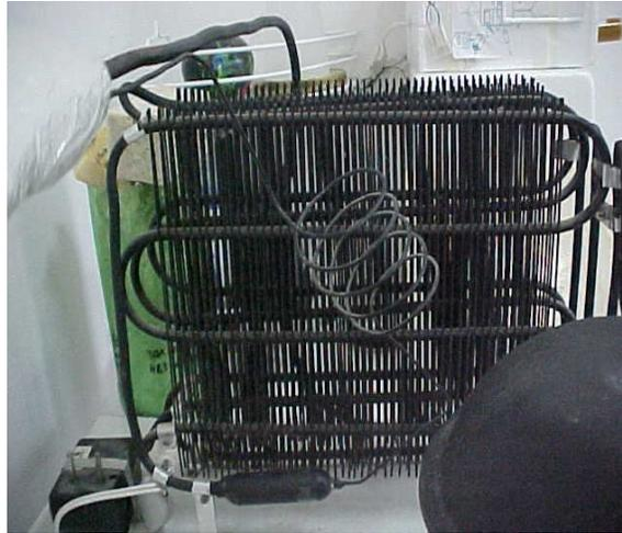
Figura 10 Condensador
