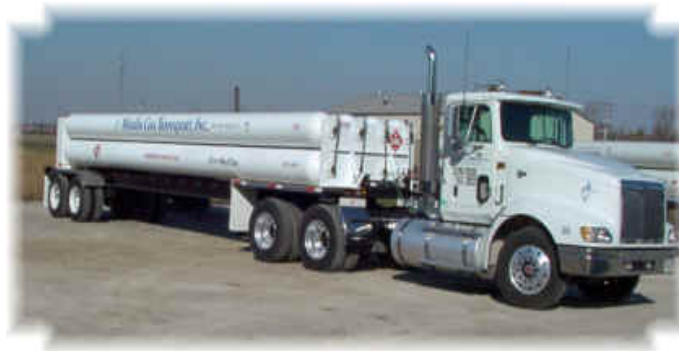
Figura 4 - Caminhão GNC Superjumbo Marlin Gas
