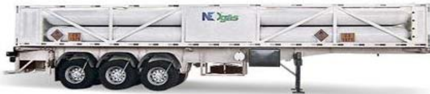
Figura 14 – Carreta Neogas com capacidade de 5000m 3 utilizando a tecnologia Hydrogas
