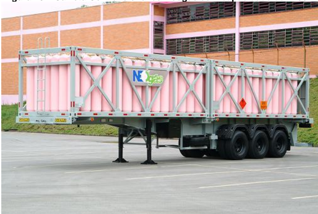
Figura 15 – Carreta Convencional da Neogas com capacidade de 7280m 3
