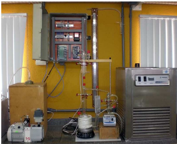
Figura 7 - Aparato desenvolvido para a Célula Othmer automatizada e para baixas concentrações.
