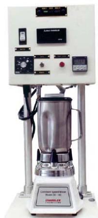
Figura 06. Waring Blendor Mixing: Utilizado na preparação da pasta de cimento.
