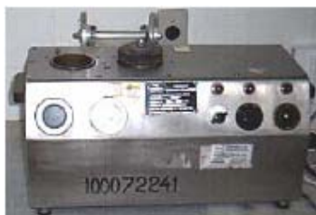
Figura 07. Consistômetro Atmosférico: Utilizado na Homogeneização da pasta de cimento.
