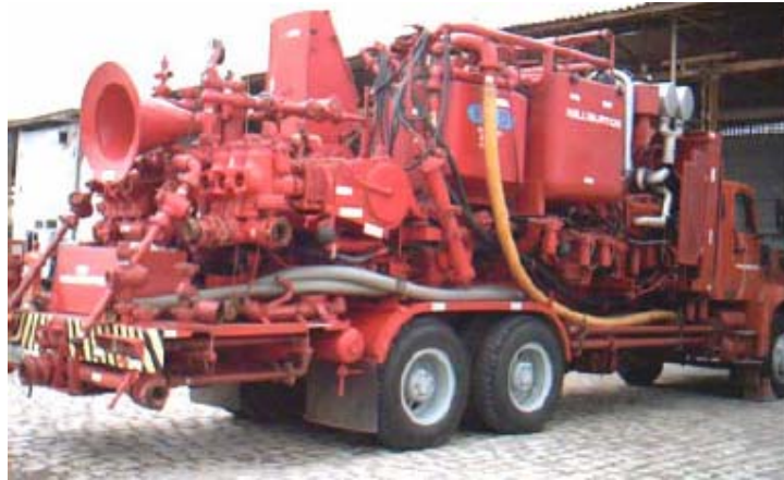
Figura 04: Unidade de cimentação
